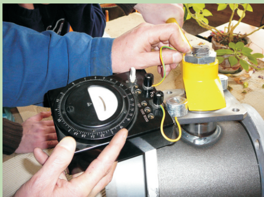
4. ábra Wheaston- híddal történő mérés
