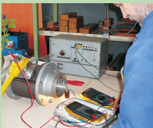
6. ábra Táp felhasználásával univerzális mérőműszerrel történő mérés, és a mérés vázlatos rajza
