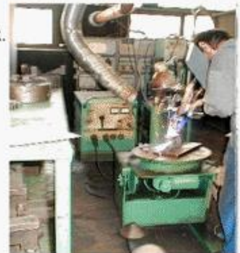
szelepház ülék felhegesztése
